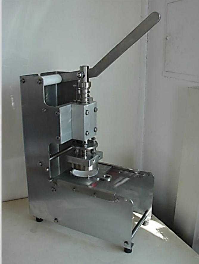
Das Handsiegelgerät ist eine Einheit zum Versiegeln vorgefertigter Becher, Schalen oder Gläser mit einer siegelfähigen Platine.
